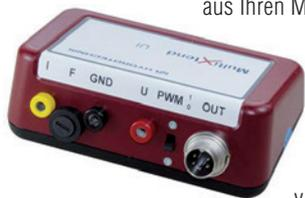
Ein **MultiXtend UI** dient der galvanischen Trennung und Wandlung von Spannung oder Strom für die Messung an einem analogen Eingang (0 ... 20 mA), wie sie von vielen Hydrotechnik Messgeräten bereitgestellt werden. Es ist mit einem zuschaltbaren PWM-Filter ausgestattet.
