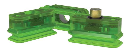
Die rechteckigen Balgsaugnäpfe werden für die Handhabung langer, schmaler Gegenstände und Flächen empfohlen, wenn maximale Haltekraft und Haftung gewünscht sind. Sie eignen sich besonders für Produkte in Kunststoff-Flowpacks, wie zum Beispiel Schokoriegel. Das Saugnapfmaterial DURAFLEX® besitzt die Elastizität von Gummi und die ausgezeichnete Verschleißfestigkeit von Polyurethan.
