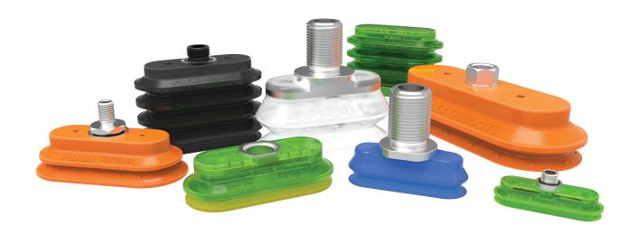
Die ovalen Balgsaugnäpfe eignen sich für die Handhabung langer, schmaler Gegenstände und Flächen, wenn maximale Haltekraft gewünscht ist. Ovale Balgsaugnäpfe sind besonders für unregelmäßige Oberflächen geeignet und wenn ein Niveauausgleich gewünscht wird. Die Baureihe der ovalen Balgsaugnäpfe weist Eigenschaften auf, die besonders für die Handhabung von Blech geeignet sind.
