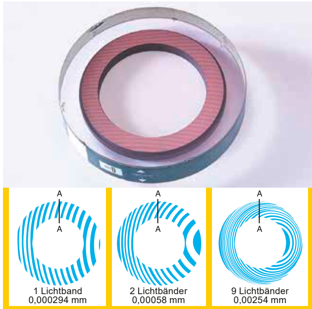
Feinstgeläppte Dichtflächen
