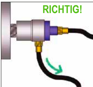
Leckageleitung zeigt immer abwärts
