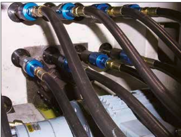
Deublin 1116 Drehdurchführung mit eigener Lagerung an Transferstraße
