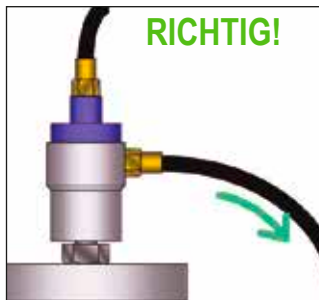
Leckageleitung zeigt immer abwärts
